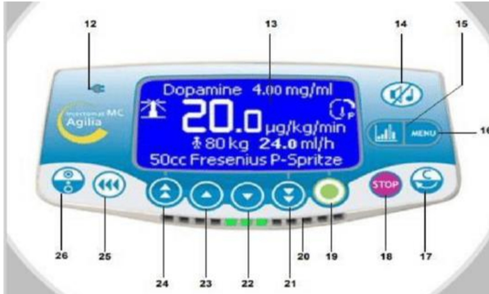
Gráfico 3: Especificación de teclas de bomba de infusión – INYECTOMAT AGILIA
