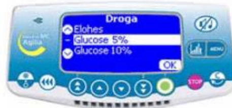
Gráfico 12: Pantalla de la bomba de infusión – VOLUMAT AGILIA
